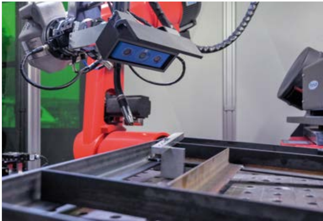
Die IPA-Software plant die Schweißbahn mithilfe von Sensordaten automatisch.
