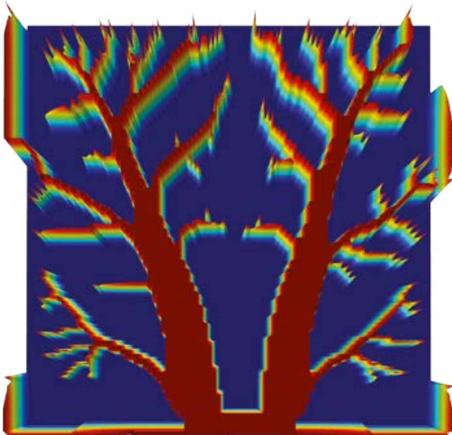
Topologieoptimierung eines Kühlkörpers.
