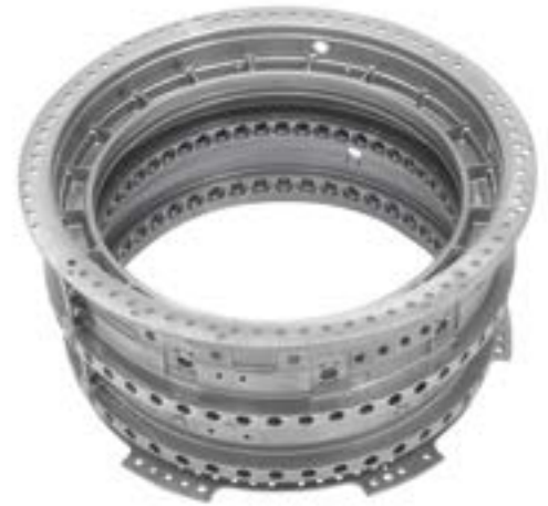
Triebwerksgehäuse sind auf maximale Stabilität ausgelegt. Sie werden deshalb aus Materialien wie Inconel, Titanlegierungen oder Waspaloy hergestellt.
