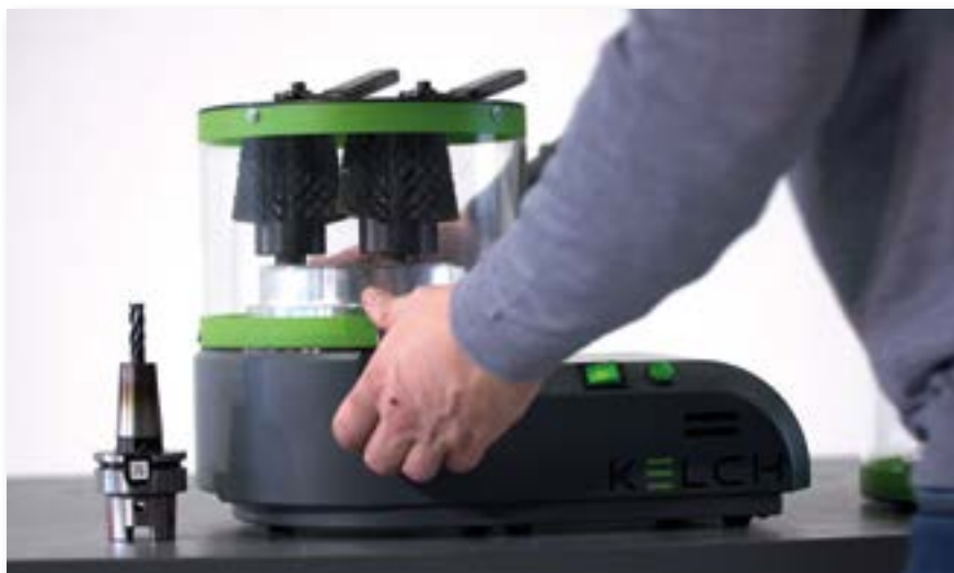
Nach dem Einsetzen des Kegels reinigt das Gerät automatisch eine Minute lang. Der Werker kann sich parallelen Arbeiten zuwenden.
