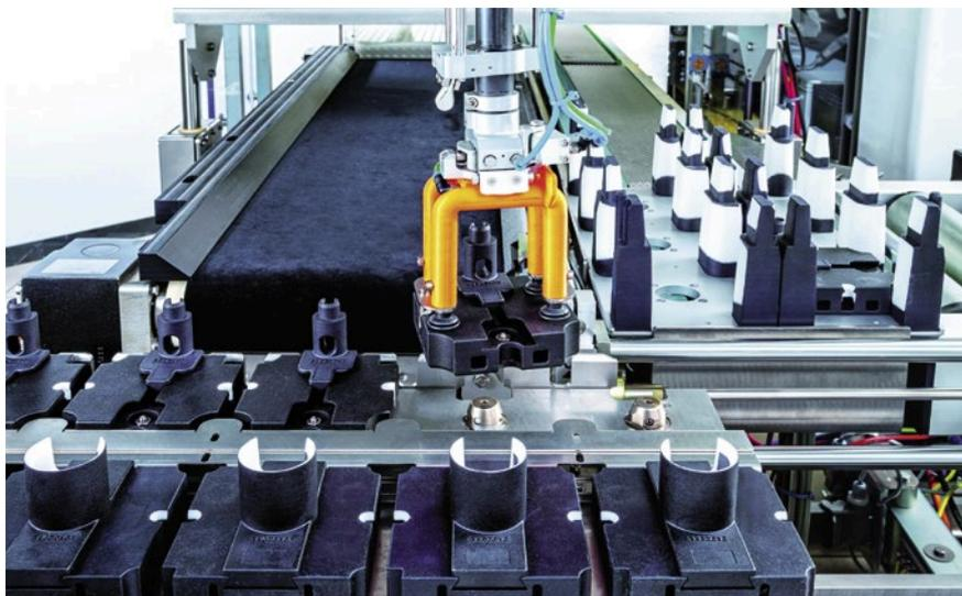
**DANK DER SCHNELL WECHSELBAREN FORMATTEILE** aus dem 3D-Druck ist die Laverana Visionsanlage sehr agil und flexibel.
