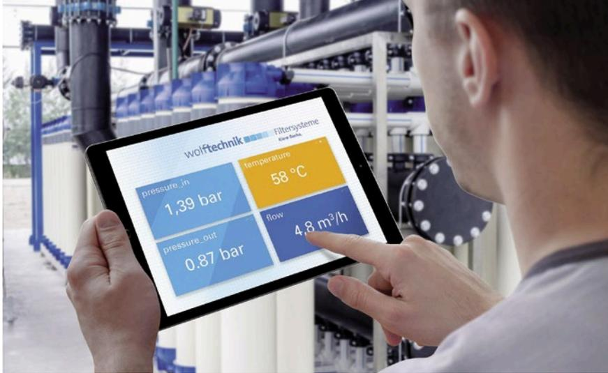
„Im ‚smarten‘ Filtersystem liefern Relativdrucksensoren vor und nach dem Filter ihren momentan gemessenen Druck über ein stromcodiertes Signal an die Smarte Filterbox, in der die Eingangssignale in einen digitalen Datenstrom umgewandelt werden.“
