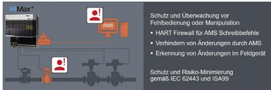
Bild 2: **DIE INTEGRIERTE SIL 3 FIREWALL** schützt vor Fehlbedienung und Manipulationen.
